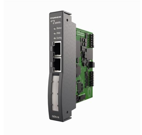
La passerelle sert à la connexion du système excom à un bus de terrain Ethernet supérieur avec prise en charge des protocoles Modbus TCP, Ethernet/IP et PROFINET. Le raccordement au bus de terrain se fait par un connecteur RJ45 standard avec une qualité de câble minimalement CAT5e. Grâce au switch intégré, une topologie annulaire suivant DLR ou MRP peut être implémentée.
